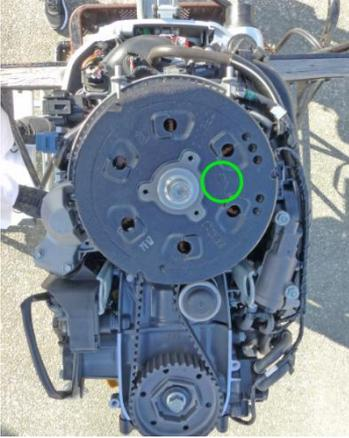
6. Den Lichtmaschinenrotor so positionieren, dass die Ausschnitte an der linken und rechten Seite des Lichtmaschinenrotors wie gezeigt liegen.
