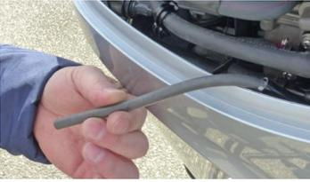
3. Lösen Sie den Ablassschlauch vom Vorsprung des Ansaugkrümmers und führen Sie das Schlauchende aus der Abdeckung heraus.
