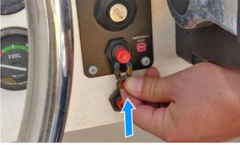
9. Setzen Sie den Notclip in den Nothaltschalter ein. Sichern Sie das andere Ende der Nothaltschalterleine am Bediener.
