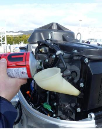
12. Füllen Sie das empfohlene Öl bis zur oberen Grenzmarkierung am Messstab nach. Nicht überfüllen. Zu viel Motoröl kann den Motor beeinträchtigen.
