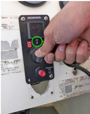
10. Drehen Sie den Motorschalterschlüssel in die Stellung EIN.
