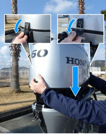
14. Lassen Sie die Lichtmaschinenabdeckung ab und bringen Sie die Motorabdeckung an. Arretieren Sie die Feststellhebel der Motorabdeckung.
