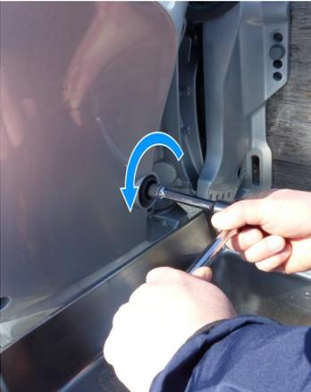
10. Stellen Sie einen geeigneten Behälter unter den Ölablassverschluss, entfernen Sie die Motorölablassschraube und die Unterlegscheibe. Lassen Sie das Altöl solange laufen, bis es nur noch herausröpfelt.
