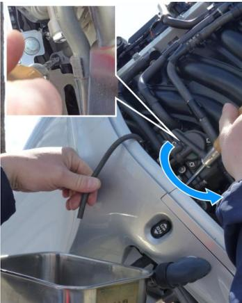
5. Lassen Sie das Benzin in die Auffangwanne ab, sobald es aus dem Ablassschlauch herausläuft.
