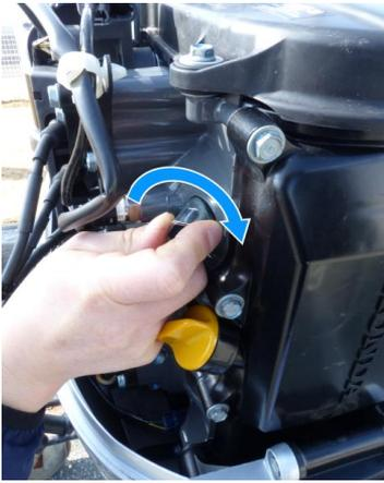
18. Drehen Sie die Zündkerzen vorsichtig von Hand ein, um ein Ausreißen des Gewindes zu vermeiden. Ziehen Sie die Zündkerzen nach dem Aufsitzen mit einer 1/8- bis 1/4-Drehung fest. Bringen Sie die Lichtmaschinenabdeckung an.
