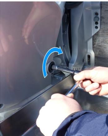
11. Montieren Sie nach dem Ablassen des Öls die Ablassschraube und die neue Dichtungsscheibe und ziehen Sie die Schraube fest an.
