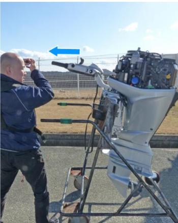
17. Ziehen Sie mehrmals den Not-Starterseilzug, um die Innenseite des Zylinders zu schmieren. Entfernen Sie anschließend den Not-Starterseilzug.
