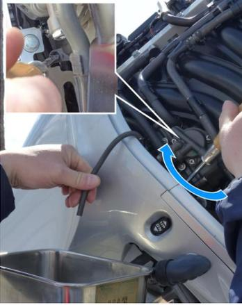
6. Ziehen Sie nach dem Entleeren die Ablassschraube an.
