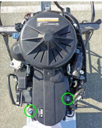
3. Entfernen Sie die beiden Schrauben und die Lichtmaschinenabdeckung.
