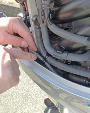
7. Befestigen Sie den Ablassschlauch am Vorsprung des Ansaugkrümmers.
